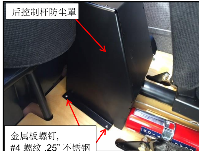
图 3 –安装了的后控制杆防尘罩
